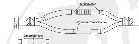
Označiti na žilama dužinu izolacione cevi simetrično na simetralu spoja. Odmastiži žilnu izolaciju i površinu spojne čaure, i obrisati ih na suvo. Nauči izolacione zgrčne cevi nad spoja, uzimanjem u obzir oznaku, da simetrično pokrivaju žilnu izolaciju. Grijenje početi od sredine.
