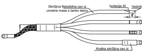
S konice žil odstranite izolacijo, glede na že izmerjene označbe f. Namestite kabelske čevlje, pri tem bodite pozorni, da bodo na ustreznih mestih za priključitev. Opravite še postopek stiskanja v vrstnem redu, kot ga prikazuje slika.
